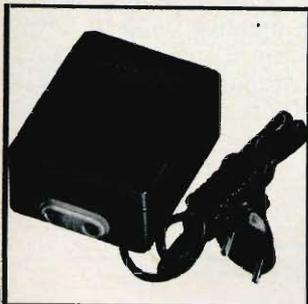
**A 3 N** Alimentatore normale adatto per tutti gli amplificatori sino ad un numero massimo di 3. Commutando internamente serve per 1, per 2 oppure per 3 amplificatori. Accensione diretta 220 V - 1,5 W c.a. - Impedenza entrata-uscita 75 Ω - NA/0720-00.
